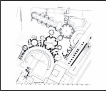
(شكل ١٠٩) قصر أنطيوخوس فى القسطنطينية (بداية القرن ٥ م)، وبه قاعة مركزية سداسية الشكل ذات حنايا، مسقط أفقى
